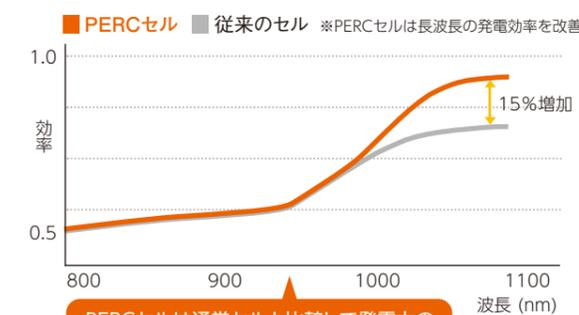
PERCセルは通常セルと比較して発電力の強い波長を15%増加吸収します。
